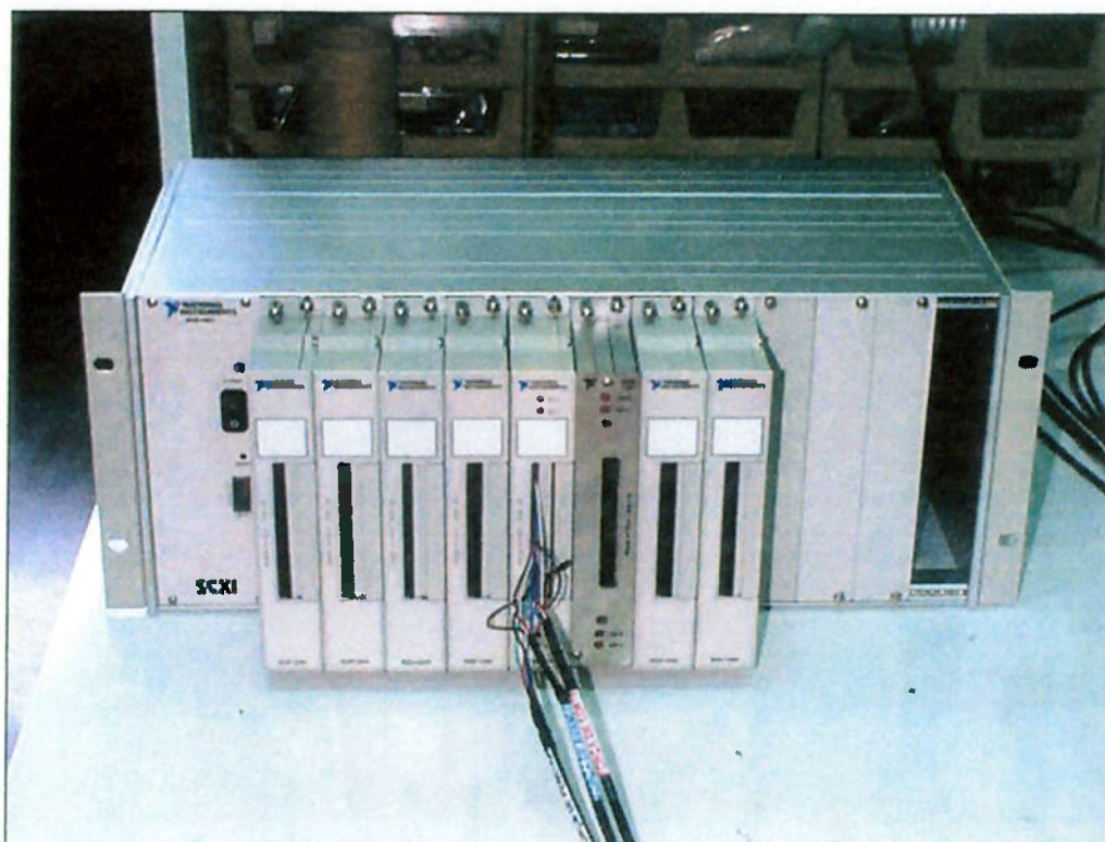
FIGURA 23: SISTEMA DE CONDICIONAMENTO DE SINAIS SCXI DA NATIONAL INSTRUMENTS.
