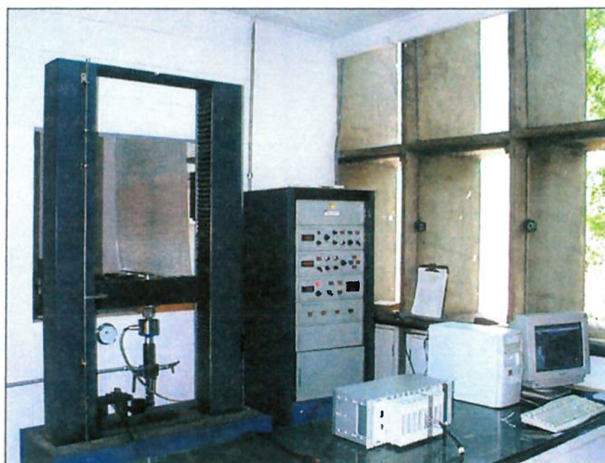
FIGURA 26: ARRANJO EXPERIMENTAL PARA A CALIBRAÇÃO DO DINAMÔMETRO.
